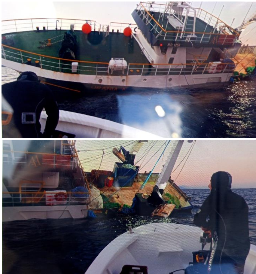
Εικόνα 12: Προετοιμασία υποβρύχιας επιθεώρησης από αυτοδύτες
